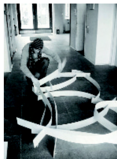
I en workshop i forbindelse med Evolution/Ny Industriel Arkitektur undersøgte en gruppe studerende, hvad man kan få ud af helt ens skåret krydsfiner elementer med ens slidser til samlinger.
