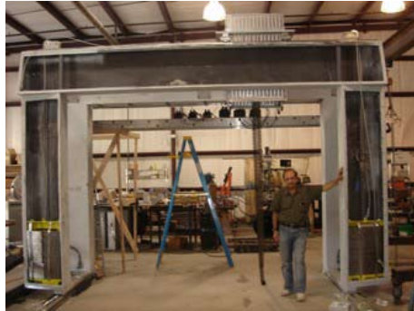
En portalkran der bevæger sig frem og tilbage på skinner i gulvet bruges til fremstilling af store elementer og potentielt hele bygninger.
