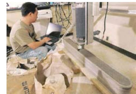
Contour Crafting kan i dag bruges til at fremstille rumstore elementer.
