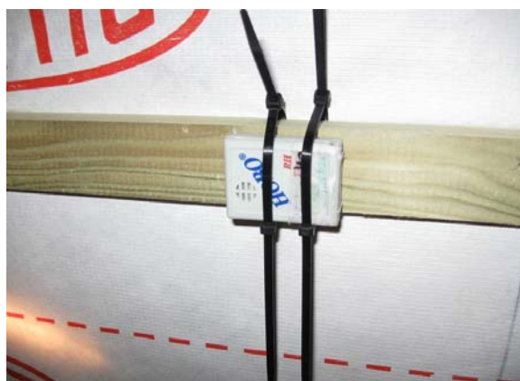
Figur 84 HOBO Relativ fugt- og temperaturmåling
