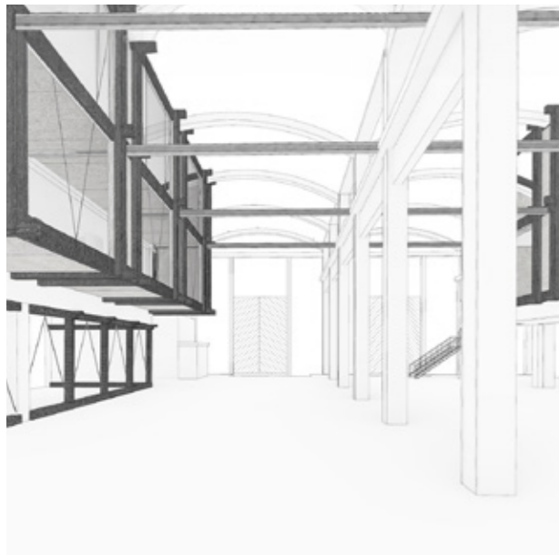
Enkel træport + afstivning af vinduesparti
