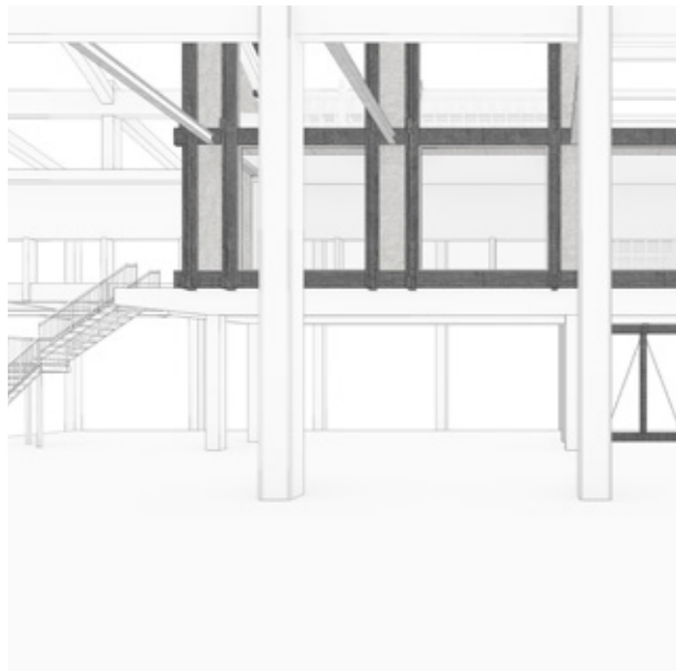
Enkel træport + afstivning af vinduesparti
