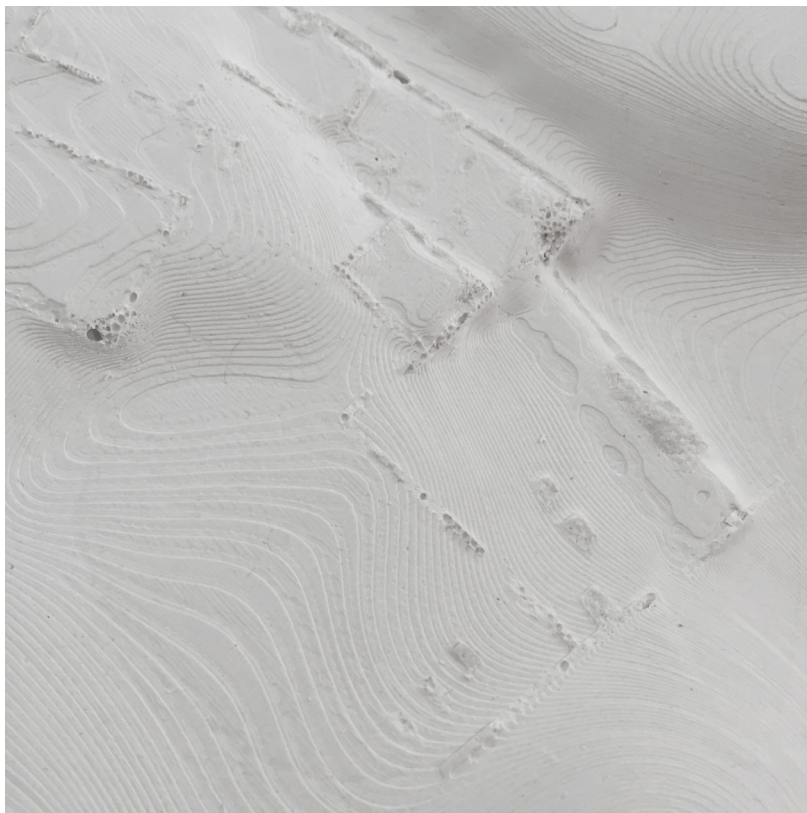
180408 | teststøbning, gips [resultat: for porøs]
