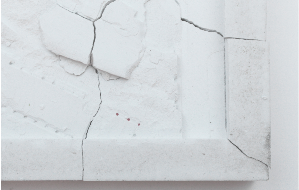
180405 | teststøbning, gips [resultat: sad fast i støbeform]
