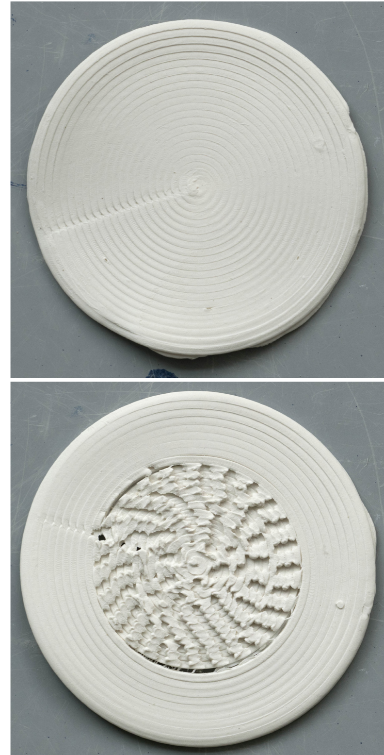
Fig.5: Exempel på interagerande med 3D-printer. Överst har printern gått av sig själv. Nederst har materialflödet styrts under print
