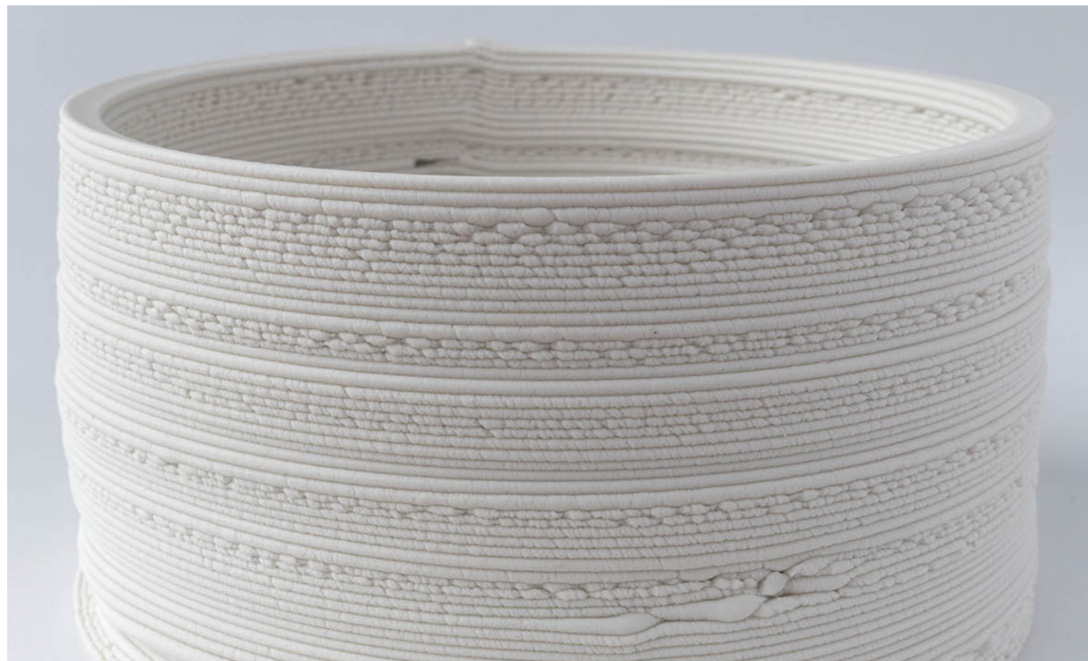
Fig.12: Exempel på manipulering av materialflöde på cylinder
